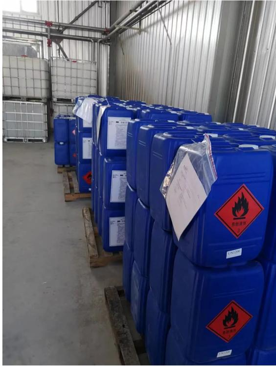
S海关对某公司申报出口的三甲基丁烷进行包装使用鉴定时，发现该货物未加贴危险货物运输标签，不符合《国际海运危险货物规则》5.2.2包装标志的相关规定。判定以上货物包装使用鉴定不合格，出具《出境货物不合格通知单》。
