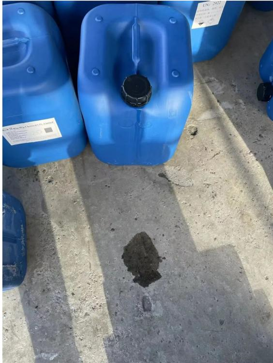
S海关对某公司申报出口的右旋苯乙胺进行包装使用鉴定时，发现该批货物包装密封不严，有部分货物泄漏在包装外表面，不符合《出口危险货物包装检验规程 第3部分：使用鉴定》（SN/T 0370.3）的规定。判定该批货物包装使用鉴定不合格，并出具不合格通知单，不准予其出口。
